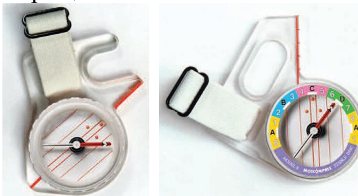
Рис. 4. Компас «на пальце» а) с фиксированной колбой, б) с цветными секторами.
